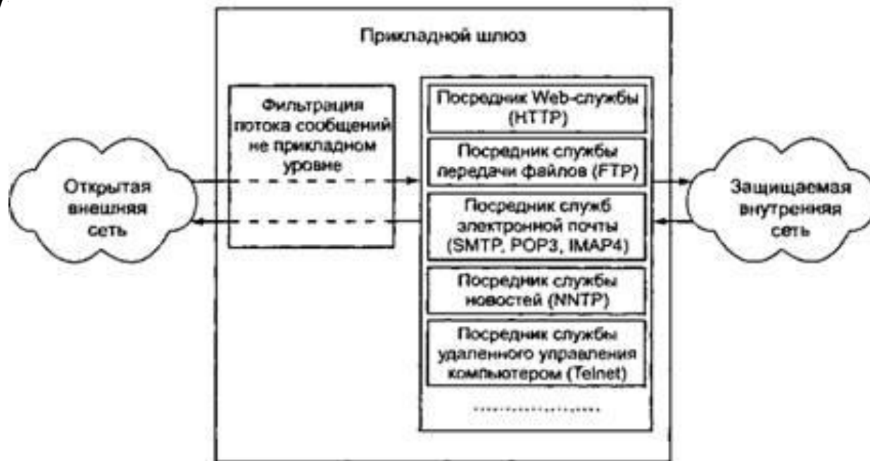
Рис. 9.6. Схема функционирования прикладного шлюза
