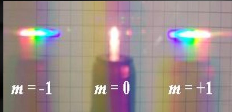
Так выглядит свет лампы накаливания фонарика, прошедший через прозрачную дифракционную решётку. Нулевой максимум ( $m=0$ ) соответствует свету, прошедшему сквозь решётку без отклонений. В силу дисперсии решётки в первом ( $m=\pm 1$ ) максимуме можно наблюдать разложение света в спектр. Угол отклонения возрастает с ростом длины волны (от фиолетового цвета к красному)
