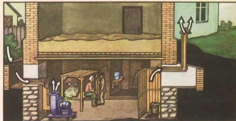
Подвал одноэтажного здания, приспособленный под противорадиационное укрытие
