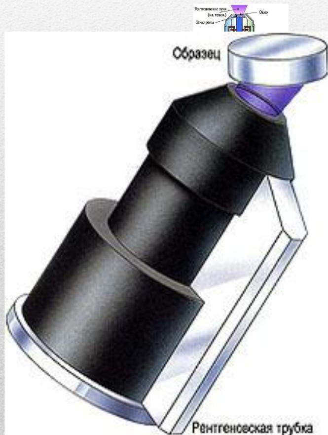
Электронны, испускаемые нитью накала, ускоряются электрическим полем до скоростей  $\sim 2 \cdot 10^8$  м/с. Узкий пучок электронов и направляется на анод, который, благодаря косому срезу, направляет возникающее на «зеркале» рентгеновское излучение в выходное окно трубки.
