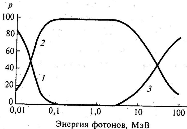
Рис. 4.2. Относительная вероятность, %, поглощения фотонов различной энергии ( $E$ ) в одном из трех видов взаимодействия излучения с веществом:
