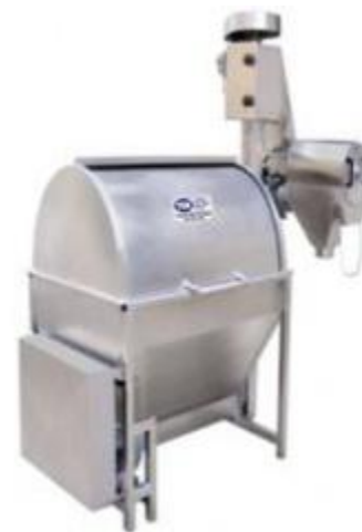
Просеиватель муки AUE250 Производительность 2500 кг/ч
