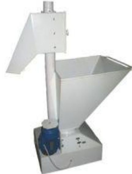
Просеиватель МПС-141, производительность 1600 кг/ч
