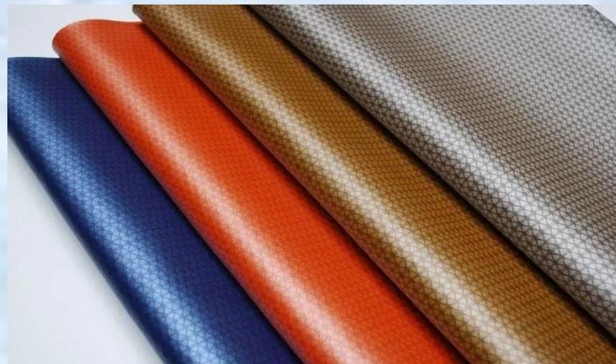
Синтетические волокна выгодно отличаются от естественных и искусственных в части прочности, эластичности, стабильности в агрессивных средах, отсутствия склонности к гниению. Но уступают последним в гигроскопичности, что ограничивает их использование, например, в качестве материала для одежды.
