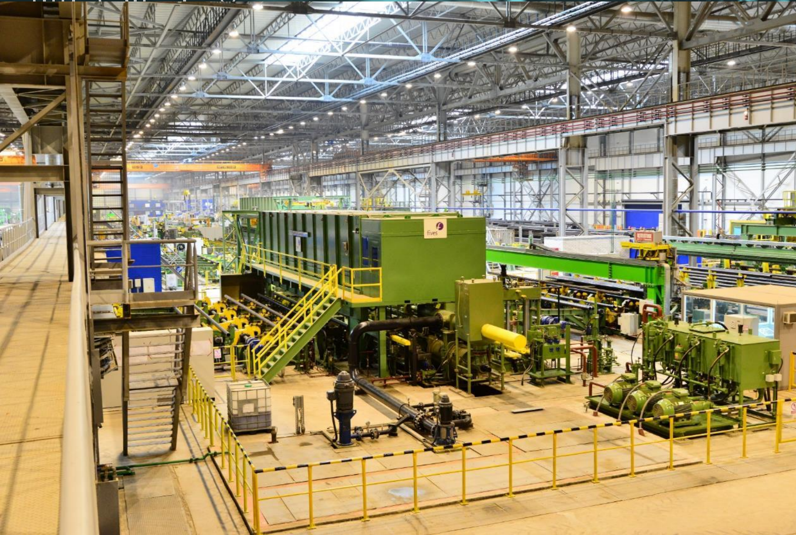
Установка гидравлического испытания труб на разрыв.
