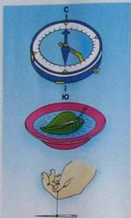
При отсутствии компаса можно использовать намагниченную иглу (булавку, лезвие безопасной бритвы)
