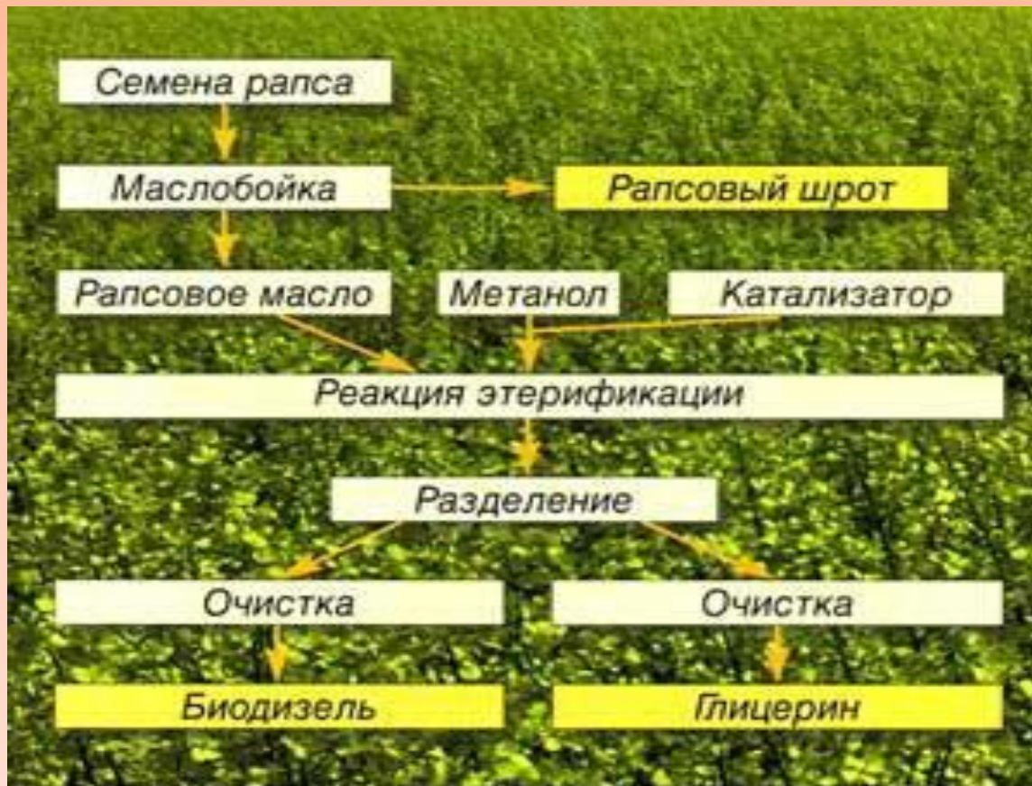
Рис. 1 Процесс получения биодизеля и побочного продукта глицерина из рапса
