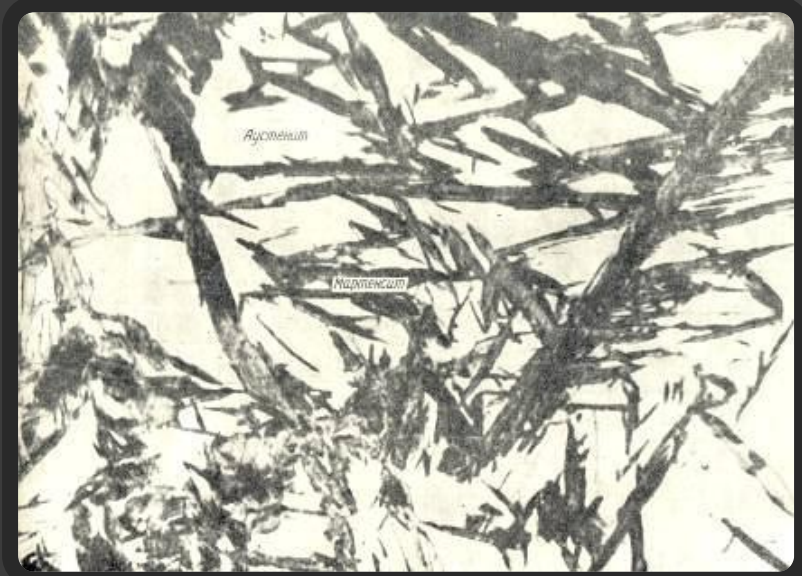
Микроструктура мартенсита ( с остаточным аустенитом )
