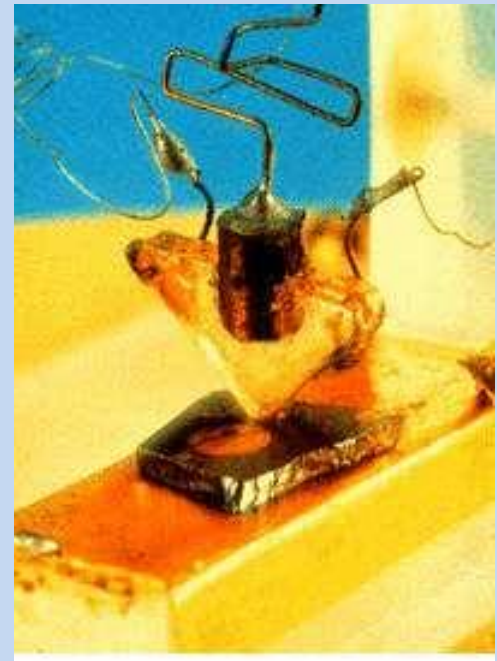
Pierwszy ostrzowy tranzystor germanowy na stole laboratoryjnym w Bell Laboratories - rok 1947
