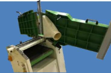
Столы откидываются поочередно, и базируются на специальных упорах, которые предотвращают повреждение станины станка. Принимающий фуговальный стол снабжен механизмом стопорения.
