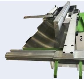
Снабжен профессиональной упорной линейкой (которая крепится к торцу подающего стола) и дает возможность устанавливать станок возле стены, тем самым не теряя площадь в цеху.
