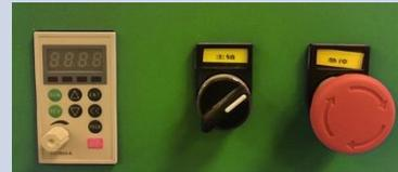
Пульт управления представляет собой контролер для регулировки частоты вращения и 2 пакетных выключателя для включения/выключения двигателя осциляции и мотора вращения шлифовального узла, кнопку аварийной остановки.
