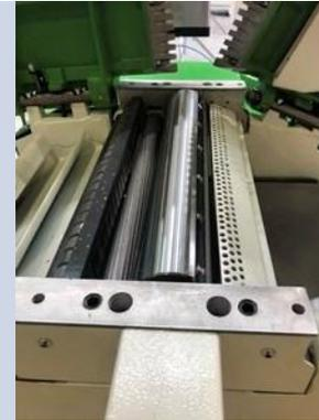
Трехножевой строгальный вал, обеспечивает идеальное качество строгания, снабжен когтевой защитой и металлическим подающим валом. Строгальные и падающие валы закреплены в массивном стальном корпусе, который эффективно гасит ударные нагрузки, возникающие в процессе работы.
