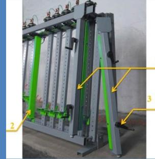
Два откатных винтовых фронтальных прижима для выравнивания и удержания заготовок (1). Боковой переставляемый упор (2). Высота рабочей зоны 1300 мм, что позволяет клеить 2 щита стандарта 640 мм.
