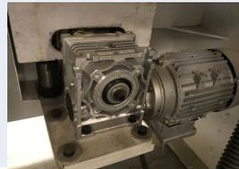
Осциляция (возвратно-поступательное движение шлифовального узла) осуществляется от отдельного двигателя. Конструкция механизма осциляции имеет массивную конструкцию из толстостенного металла, что исключает любое отклонение от оси обработки в процессе работы станка.
