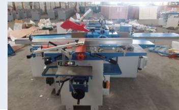
Оснащен упорами ограничения ширины и глубины паза, а так же эксцентриковым прижимом.
