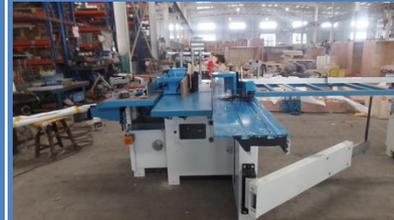
Станок оснащен высокоточной кареткой, что обеспечивает высокую точность раскроя, с том числе при работе с наклонным пильным диском. Телескопическая опора каретки обеспечивает исключение люфта при пилении и позиционировании габаритных заготовок.
