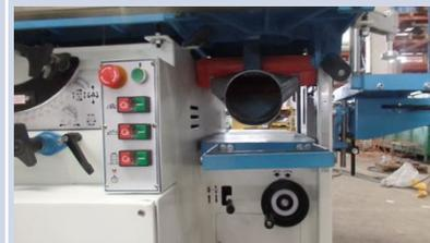
Строгальный узел станка имеет 3-х ножевой вал, что обеспечивает высокое качество строгания заготовок. Столы изготовлены из чугуна усиленного ребрами жесткости, что исключает вибрации и улучшает качество строгания.
