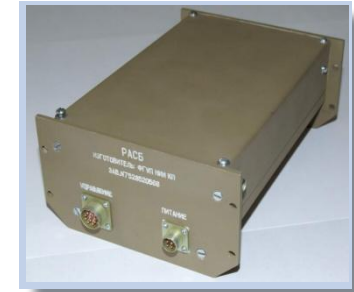
Аварийный радиобуй для подводных лодок РАСБ
