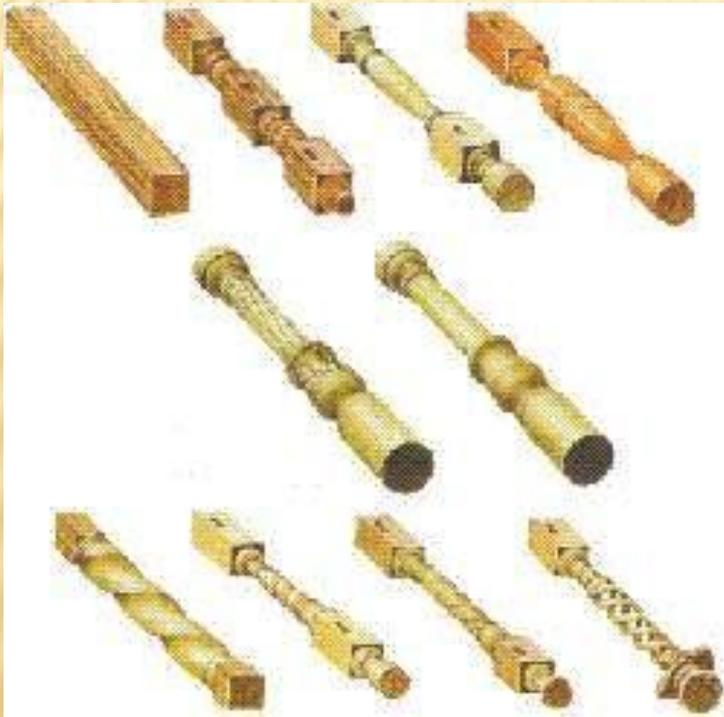
Напомним, что в настоящее время точением называют обработку древесины резанием, при котором из заготовки получают изделия в виде тел вращения - цилиндры, конусы, шары. В домашнем обиходе есть множество предметов, изготовленных на токарных станках.
