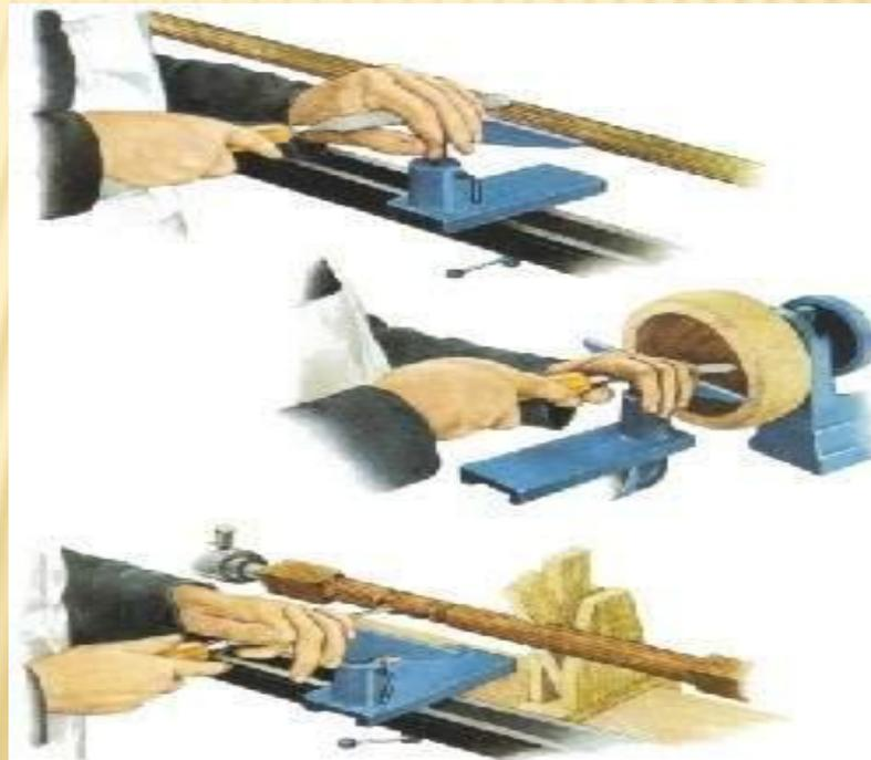
На токарном станке вытачивают изделия, контур которых может состоять из нескольких объёмных геометрических фигур. Это фигуры – шар, конус, цилиндр и тор (см. рисунок).
