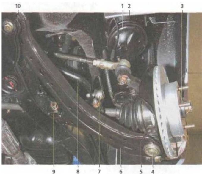
Элементы передней подвески: 1 — амортизаторная стойка; 2 — пружина; 3 — ступица колеса; 4 — шаровая опора; 5 — поворотный кулак; 6 — рычаг; 7 — стойка стабилизатора поперечной устойчивости; 8 — штанга стабилизатора поперечной устойчивости; 9 — передний сайлент-блок рычага; 10 — задний сайлент-блок рычага.
