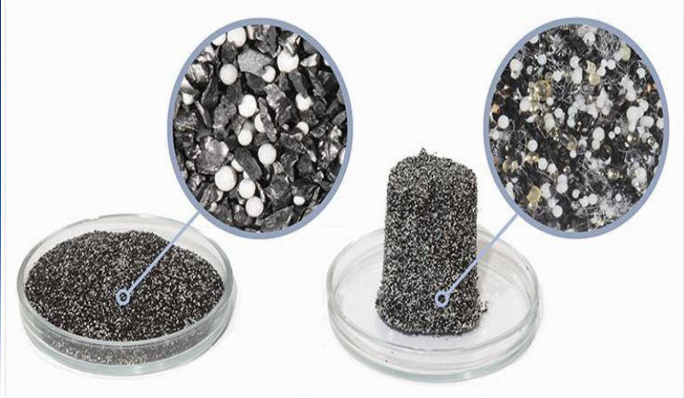
Сорбционная смесь обычного угольного фильтра (слева) и фильтра АКВАФОР (справа).
