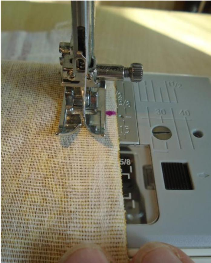
Раскладывание припусков шва стачивания боковых срезов и одновременно припусков на обработку
