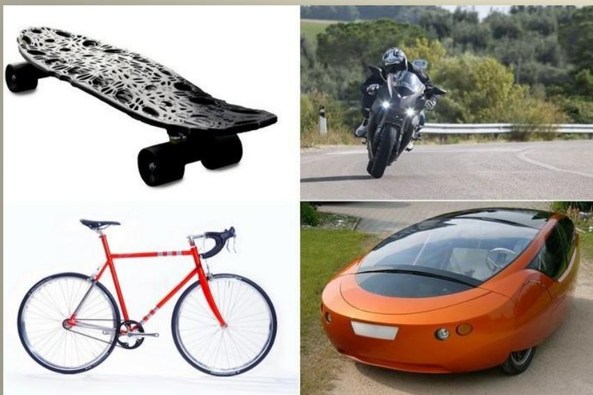
Многие детали Urbee 2 сделаны из прочной пластмассы. Вес такого авто составляет всего 500 килограмм. Автомобиль оснащен гибридной установкой — классическим сочетанием бензинового мотора и пары его электрических собратьев. Первый отвечает за заднюю ось, а вторые — за переднюю. Максимальная скорость 3D-машины составляет 112 км/ч. Одного заряда батареи хватит на то, чтобы проехать 64 километра.
