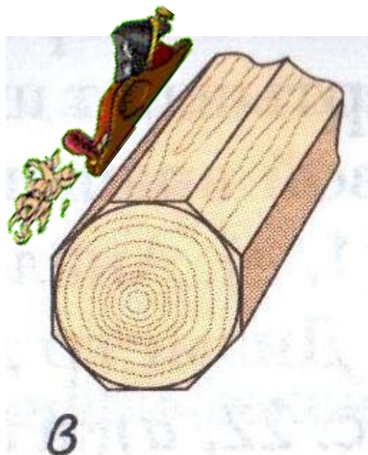
Рис. 1. Последовательность изготовления детали цилиндрической формы ручным инструментом.
