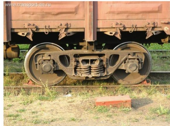
**Тормозными башмаками, стационарными устройствами для закрепления вагонов, ручными тормозами или другими средствами закрепления,**
