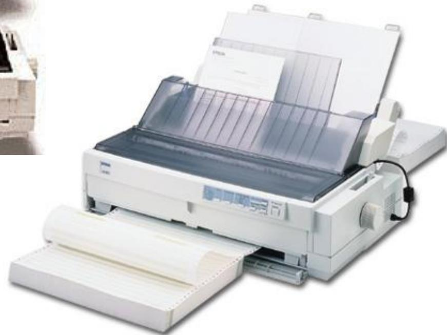
**Матричные принтеры** являются одними из первых устройств автоматической печати. Их конструкция включает в себя печатающую головку (каретку), которая движется вдоль строки и наносит символы ударами иголок, прижимающих ленту, пропитанную чернилами, к бумаге. Матричными такие принтеры называются потому, что все доступные для печати символы являются частью матрицы, образуемой расположением игл (которых может быть, например, 9 или 24).
