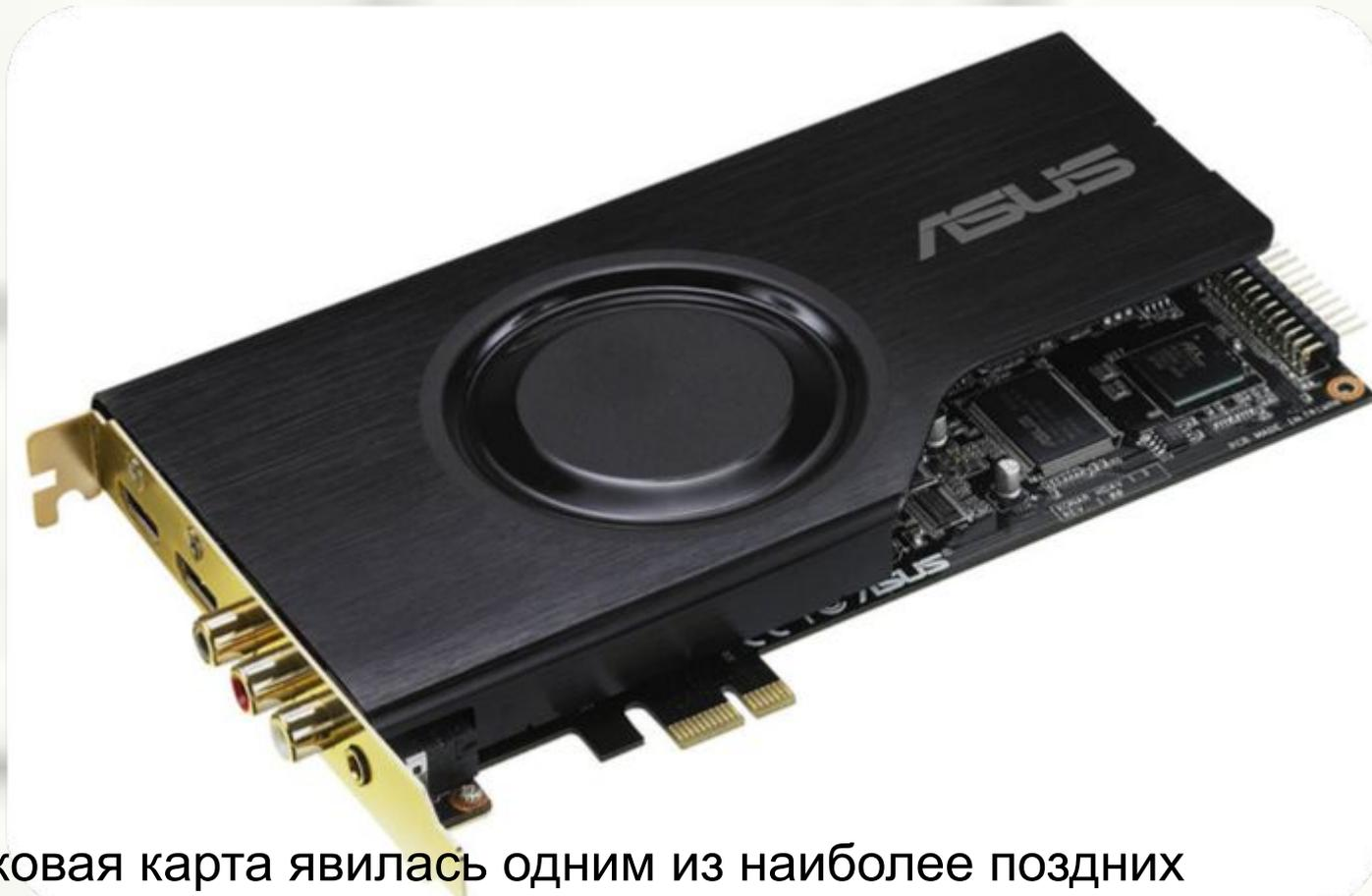
Звуковая карта явилась одним из наиболее поздних усовершенствований персонального компьютера. Она устанавливается в один из разъемов материнской платы в виде дочерней карты и выполняет вычислительные операции, связанные с обработкой звука, речи, музыки.
