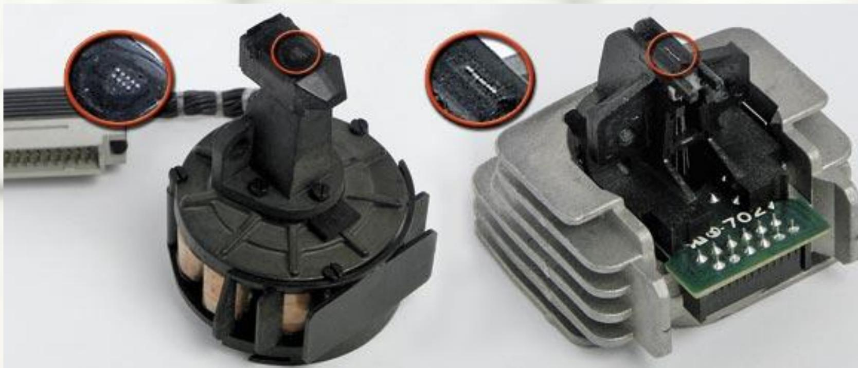
Иглы приводятся в движение небольшим электромагнитом
