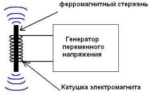
к никеля), обладающего свойством под поля сжиматься и растягиваться, металлической икрепленной к корпусу 1. Через катушку ный электрический ток (в источнике волн) или, ает ток (в приёмнике волн).
