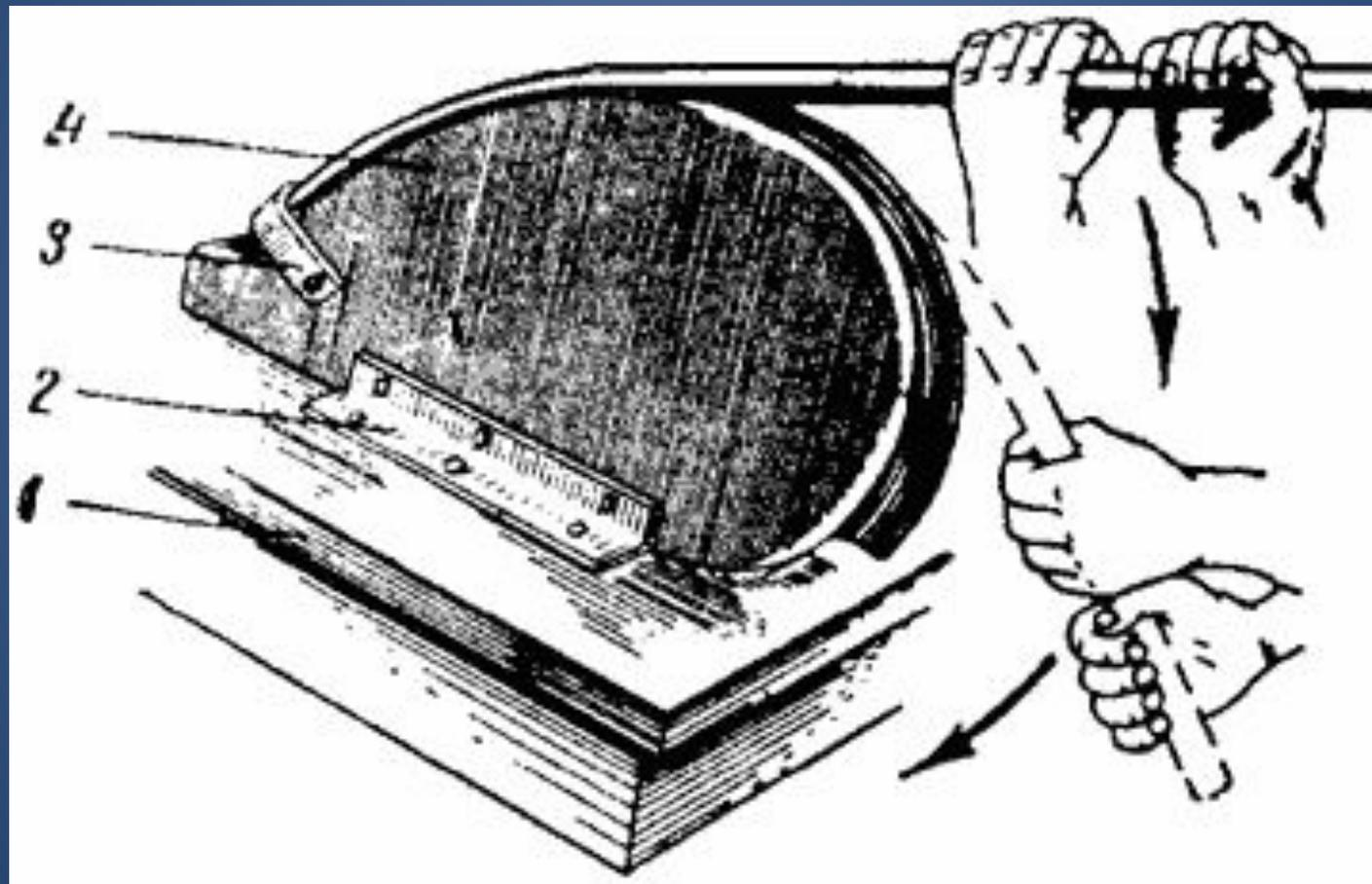
Приспособление для гибки труб диаметром до 20 мм в холодном состоянии состоит из плиты 4, гибочного ролика 3, нажимного ролика 7, рукоятки 6, упора 2, зажимного устройства 5. Приспособление крепится в слесарных тисках 1. При повороте рукоятки подвижной ролик давит на трубу и огибает ее по гибочному ролику до тех пор, пока ее конец не упрется в упор, после чего труба изгибается на участке, находящемся между гибочным роликом и упором, в результате получается труба с двумя изгибами.
