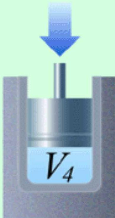
Дальнейшее сжатие производится в **адиабатных условиях**. Работа, затраченная на сжатие идет на увеличение внутренней энергии, в результате чего **температура газа увеличивается до  $T_1$**
