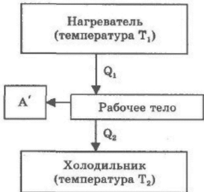
**Теплоемкость каждого источника столь велика, что отъем рабочим телом теплоты от одного источника и передача его другому практически не меняет их температуры.**
