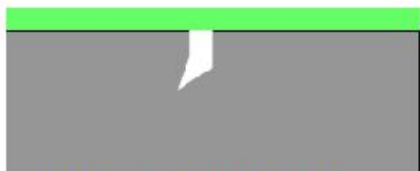
Нанесение пенетранта на поверхность
