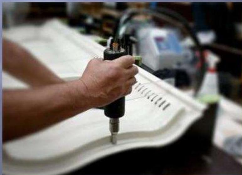
Заготовки с небольшим усилием сжимаются инструментом, на который накладываются продольные или поперечные ультразвуковые колебания.
