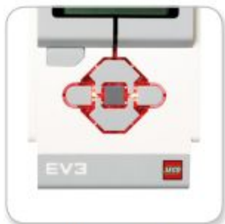
Индикатор состояния модуля – Красный
