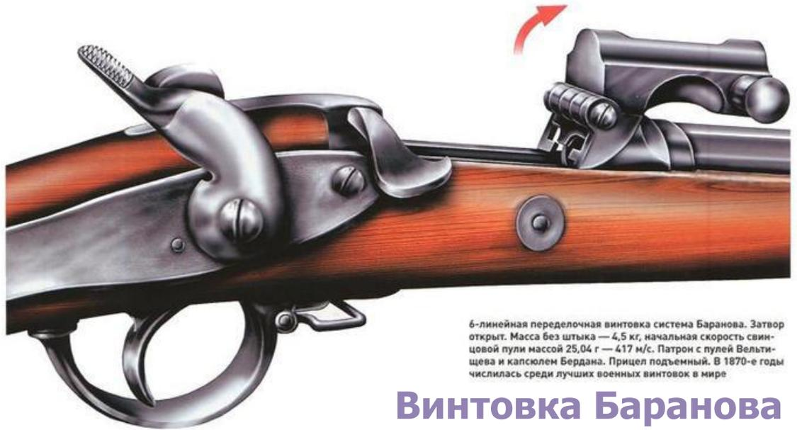
6-линейная переделочная винтовка система Баранова. Затвор открыт. Масса без штыка — 4,5 кг, начальная скорость свинцовой пули массой 25,04 г — 417 м/с. Патрон с пулей Вельтищева и капсюлем Бердана. Прицел подъемный. В 1870-е годы числилась среди лучших военных винтовок в мире.
