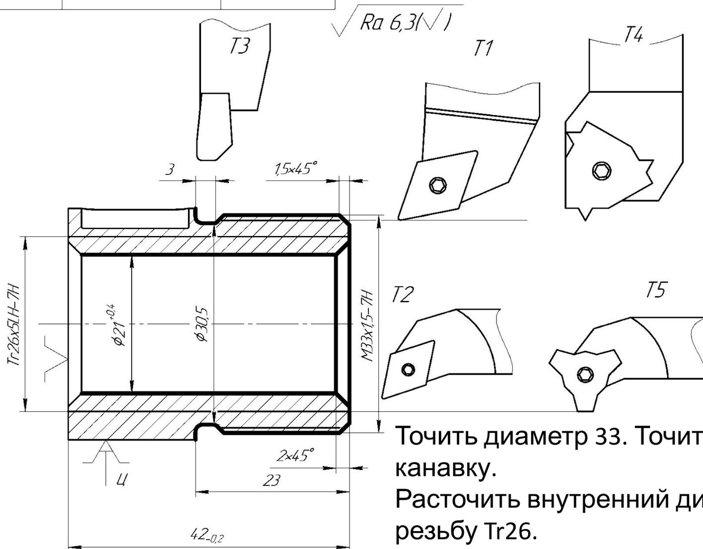
Точить диаметр 33. Точить резьбовую канавку.
