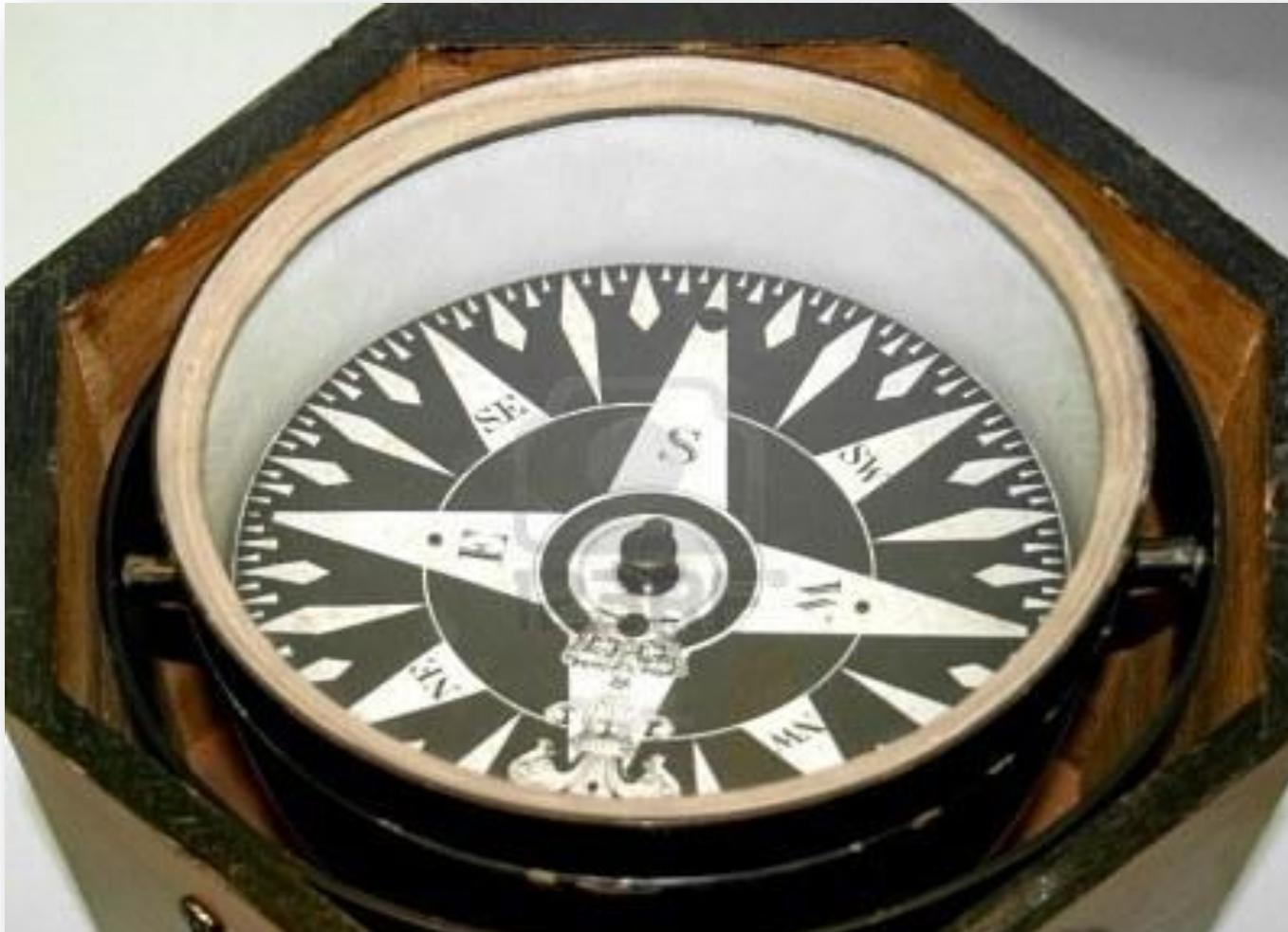
К стрелке была прикреплена картушка (лёгкий круг), разбитая на 16 румбов. Спустя два столетия деление картушки составляло 32 румба, а коробку со стрелкой начали помещать в специальном карданном подвесе. Таким образом качка корабля перестала влиять на компас.
