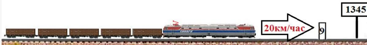
Если причиной толчка послужили: лопнувший рельс, размыв пути, обвал, выброс пути и другие неисправности пути, угрожающие безопасности движения поездов, дальнейшее следование поезда по опасному месту разрешается только после осмотра данного места работником пути (должностью не ниже бригадира) и обязательной записью им в бланке ДУ-61 о возможности проследовать опасное место с указанием скорости движения.
