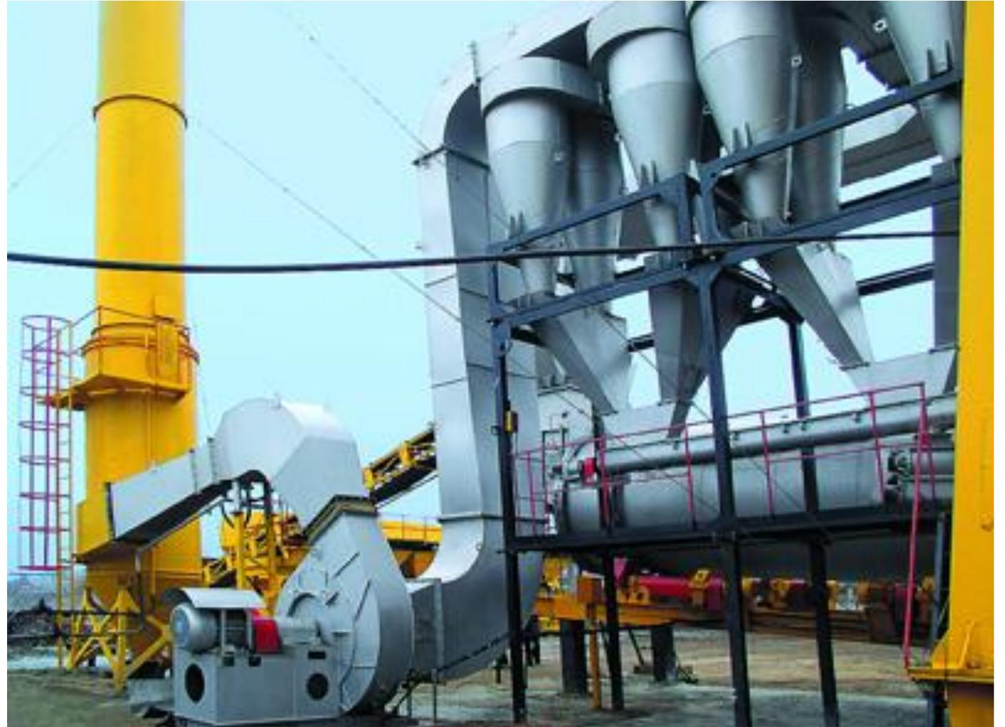
Циклон улавливает до 95-98 % частиц пыли размером 10-20 мкм
