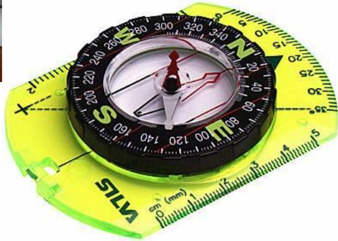
**Азимут – угол между направлением на север и направлением на какой-то предмет, отсчитываемый от направления на север по часовой стрелке.**
