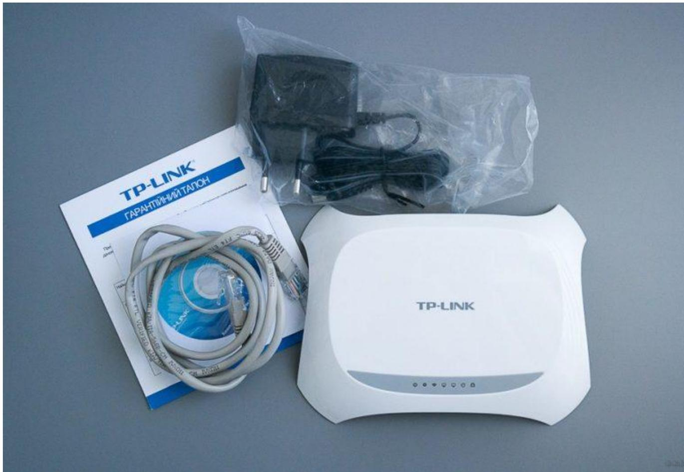
TL-WR720N – это маршрутизатор для работы с проводными и беспроводными сетями, где в качестве источника внешнего сигнала используется соединение по Ethernet-кабелю. Характерные особенности роутера – футуристический дизайн и компактные размеры.
