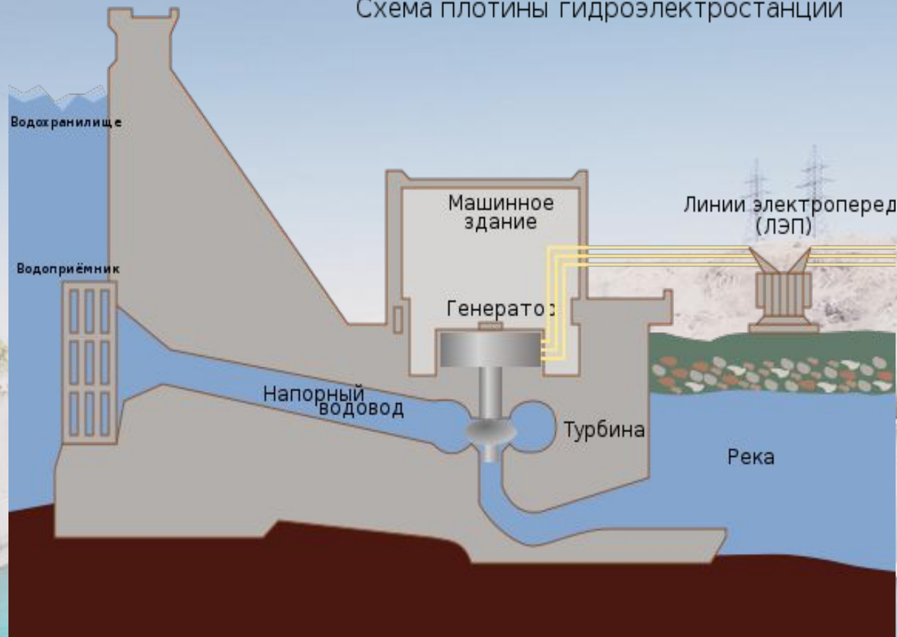
Схема плотины гидроэлектростанции
