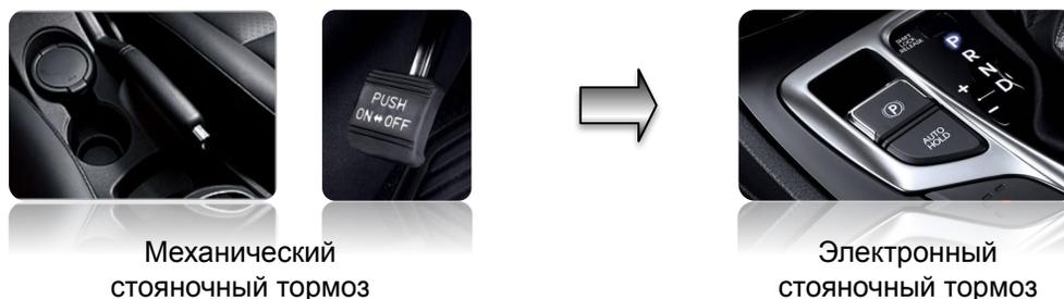
EPB — аббревиатура для системы стояночного тормоза с электронным управлением. После получения входного сигнала (или, при выключении зажигания, автоматически) от водителя модулем управления EPB приводится в действие электродвигатель включения стояночного тормоза в задней части обоих барабанов.
