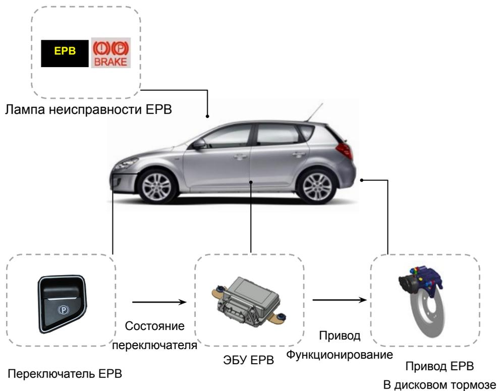
В случае типа «суппорт» включение и выключение стояночного тормоза выполняет привод EPB, которым управляет ЭБУ EPB по сигналу от выключателя EPB. Система поддерживает связь с ESC для автоматического включения и выключения тормоза (AVH) в случае остановки транспортного средства (на светофоре). Этим предотвращается качение транспортного средства назад. EPB также включается в аварийных ситуациях для обеспечения дополнительной безопасности.
