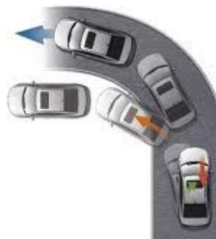
Управление тормозом и двигателем для управления поведением автомобиля
