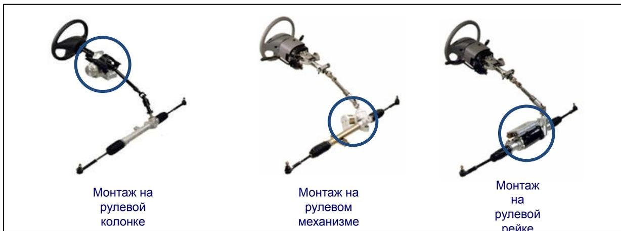
EPS можно разделить в зависимости от места расположения электродвигателя на три основных типа: с монтажом на рулевой колонке, на рулевом механизме и на рейке. Чем ближе электродвигатель расположен к колесам, тем выше передаваемый момент. Этот вариант наиболее приемлем для средне- и крупногабаритных транспортных средств. Однако чем сложнее система, тем выше стоимость разработки.
