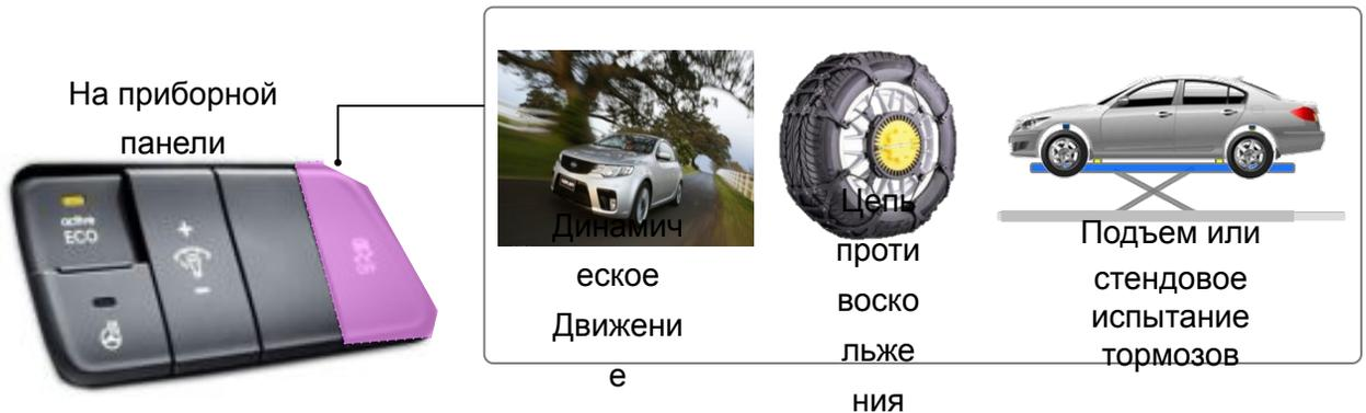
С помощью выключателя ESC водитель может выключить систему ESC. При отправке HECU сигнала «выкл» загорается сигнализатор ESC OFF. Выключатель ESC используется при следующих обстоятельствах.
