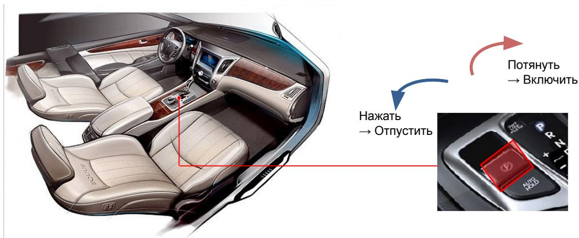
Переключатель EPB используется для передачи намерения водителя применить стояночный тормоз. Он расположен на напольной консоли, как показано на рисунке. При повороте выключателя на ЭБУ EPB посылается сигнал. Переключатель EPB подключен через двойную цепь для увеличения надежности системы. Привод EPB активируется только после получения сигнала от 2 контактов.
