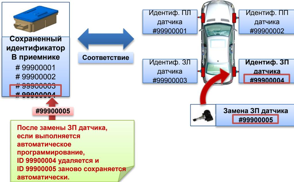
\* Пример автоматического программирования. Идентификаторы назначены в случайной последовательности.
