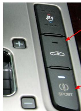
Переключатель управления высотой автомобиля
