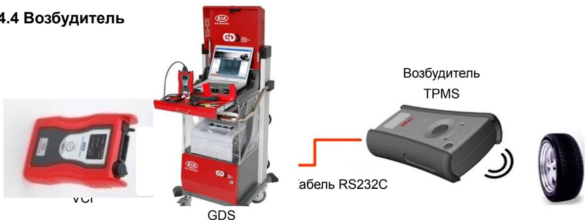
Возбудитель TPMS разработан специально для выполнения различных операций технического обслуживания датчика давления. Нашей компанией разработан и распространяется в Корею возбудитель TPMS, который может быть подключен с помощью кабеля к GDS для выполнения различных операций. Описание его основных функций приводится ниже.
