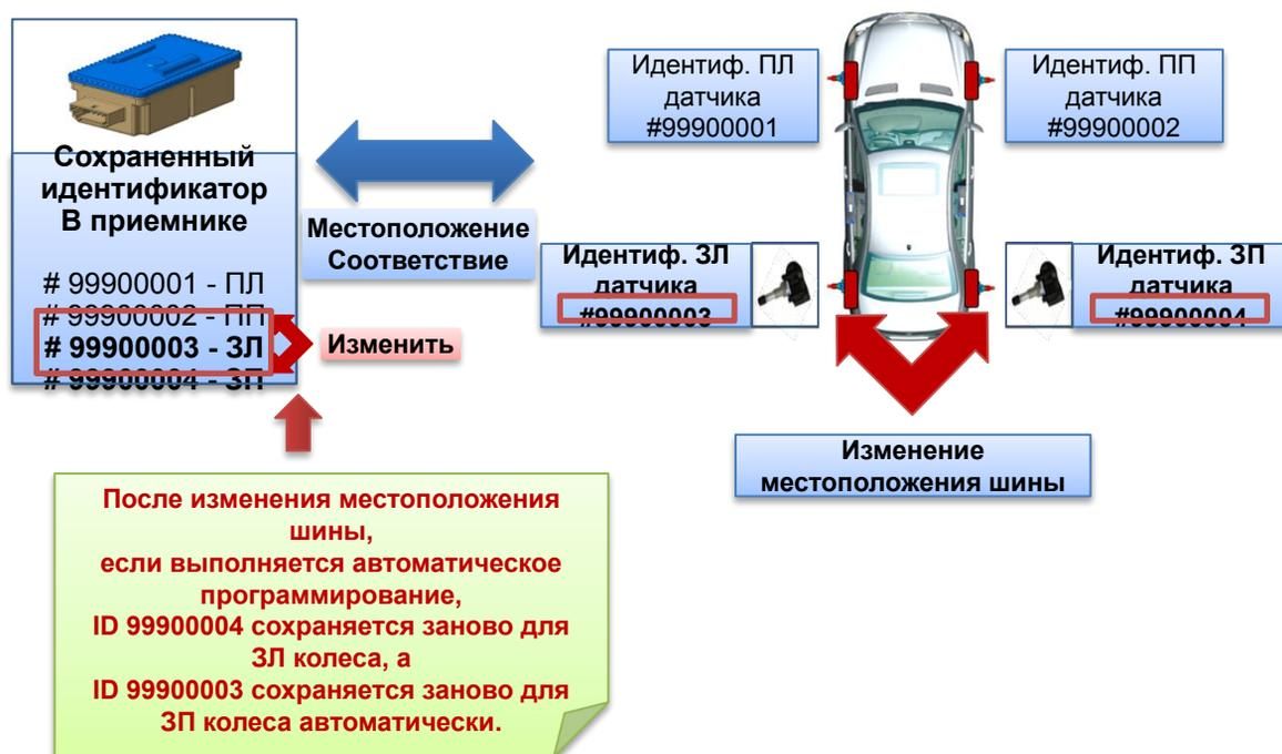
\* Пример автоматического определения местоположения. Идентификаторы назначены в случайной последовательности.
