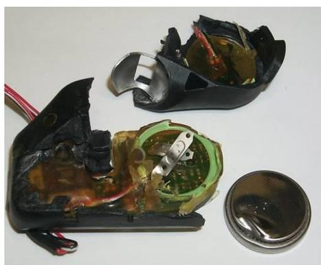
Датчик, поврежденный в результате монтажа шины
