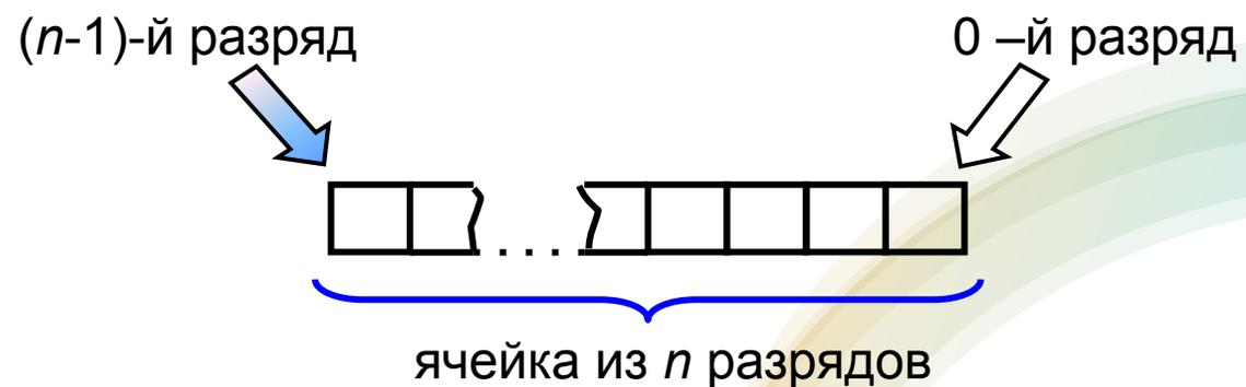
Каждый такой элемент служит для хранения одного из битов - разрядов двоичного числа. Именно поэтому каждый элемент ячейки называют *битом* или *разрядом*
