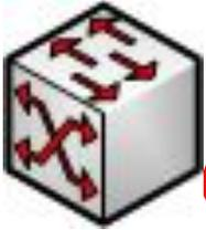
**Коммутатор (Switch)** делит сеть на независимые подсети, изолируя трафик одной подсети от трафика другой подсети с целью уменьшения возможности несанкционированного доступа к данным.
