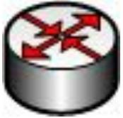
**Маршрутизатор (Router)** – сетевое устройство, используемое в сетях передачи данных, которое на основании информации о топологии сети и алгоритмов обслуживания принимает решения о пересылке пакетов получателю.
