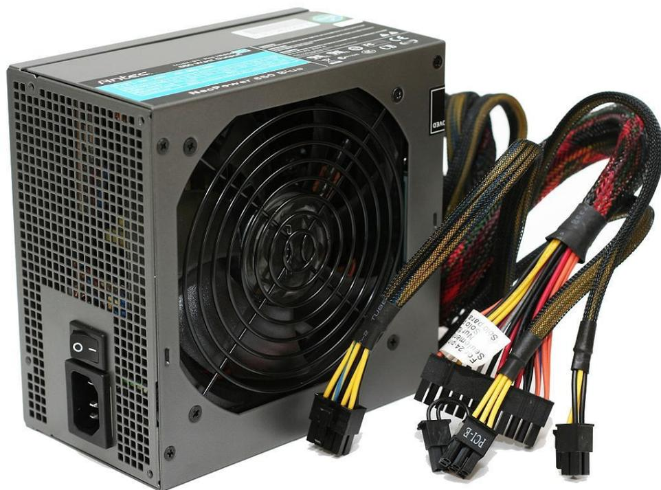
**1Я** Блок питания (БП) – это блок, который подает электрическую энергию на компоненты системного блока. Всем компонентам системного блока необходимо питание (энергия) для работы, так же как лампочке или телевизору. Именно в него вставляется кабель, по которому ток идет из розетки в системный блок.
