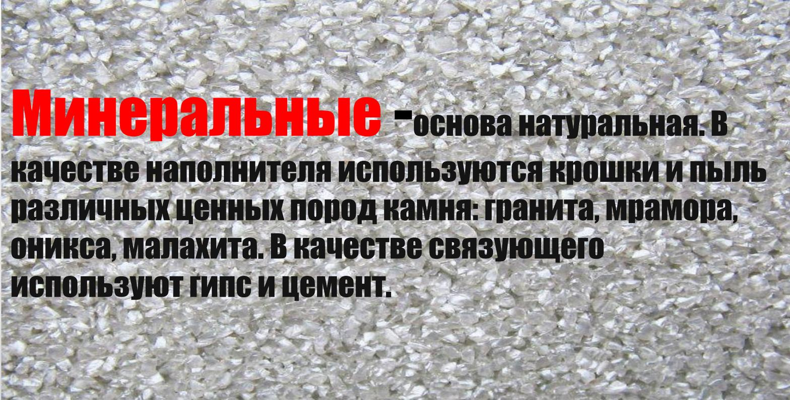
**Минеральные** — основа натуральная. В качестве наполнителя используются крошки и пыль различных ценных пород камня: гранита, мрамора, оникса, малахита. В качестве связующего используют гипс и цемент.
