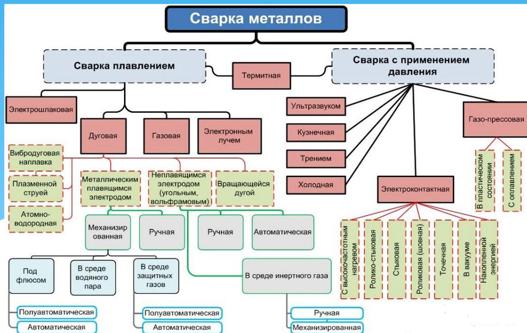
**Сварка плавлением** осуществляется плавлением сопрягаемых поверхностей без приложения внешней силы, обычно, но не обязательно, добавляется расплавленный присадочный металл.
