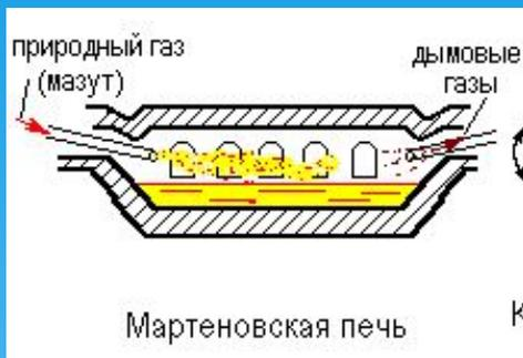
Самая крупная сталеплавильная печь – *мартеновская*. Печь представляет собой ванну из огнеупорных материалов. Сверху имеется свод, в передней стенке расположены окна для завалки шихты, в нижней части задней стенки – летка для выпуска стали. В боковых стенах имеются головки для подачи топлива и отвода продуктов сгорания. Источником тепла является факел, в котором сгорает природный газ или мазут.
