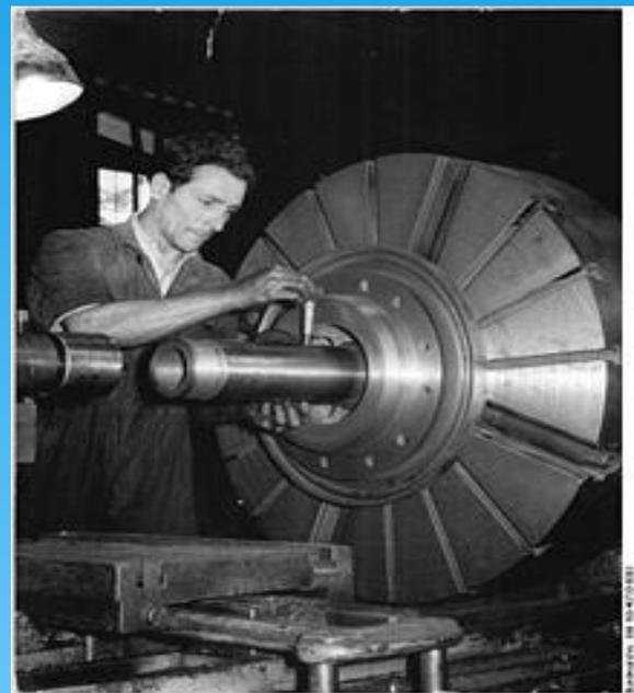
**Точение** - наиболее распространенный метод изготовления деталей типа тел вращения (валов, дисков, осей, пальцев, цапф, фланцев, колец, втулок, гаек, муфт и др.) на токарных станках.
