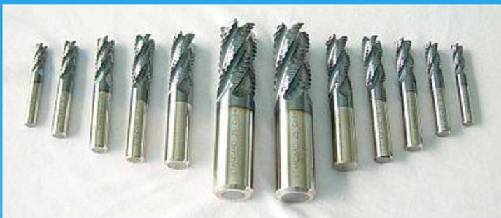
**Фрезерование** (*фрезерная обработка*) — это процесс механической обработки, при котором режущий инструмент (фреза) совершает вращательное движение (со скоростью  $V$ ), а обрабатываемая заготовка — поступательное (со скоростью подачи  $S$ ).
