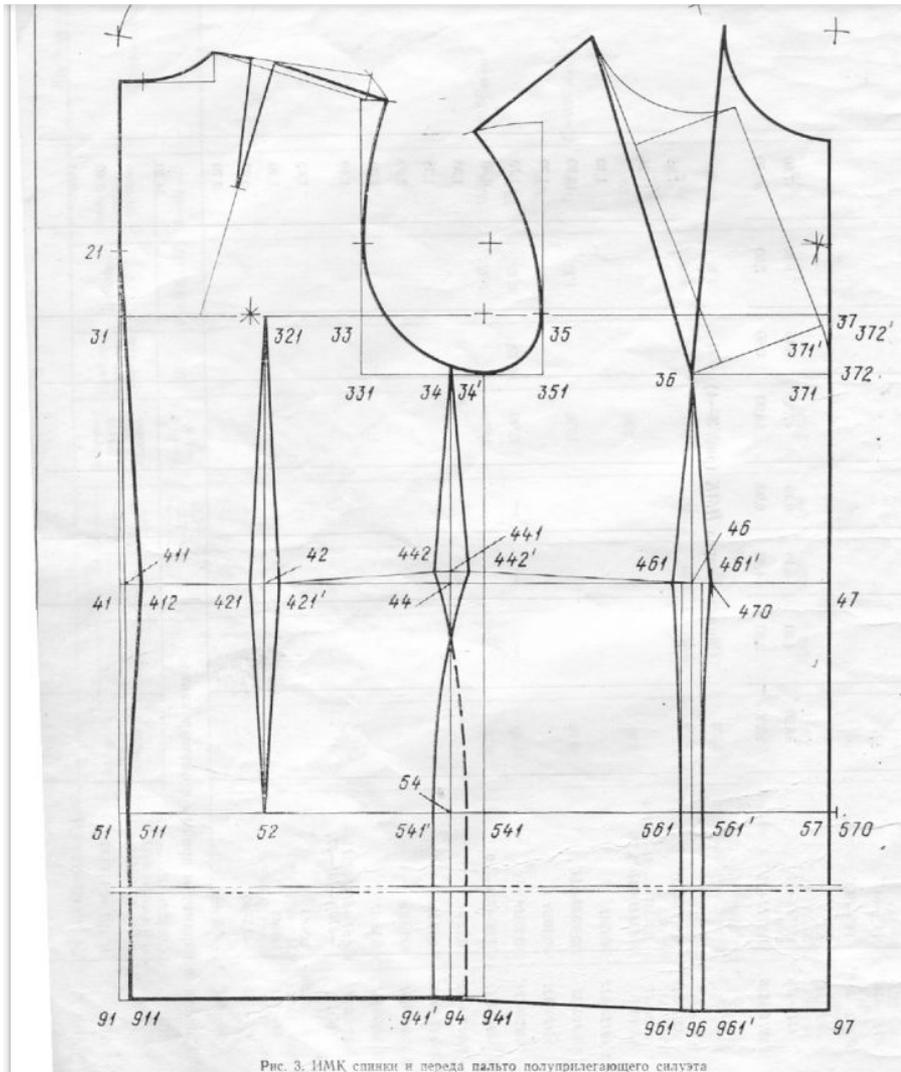
Рис. 3. ИМК спинки и переда пальто полуприлегающего силуэта
