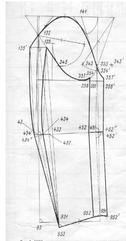
Рис. 4. ИМК спинки пальто полуприлегающего силуэта
