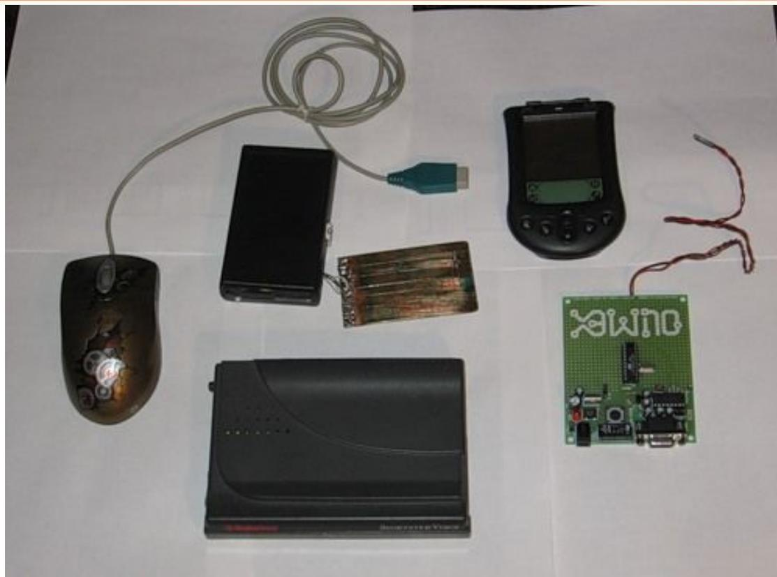
Устройства, которые имеют на своём борту UART, по часовой стрелке: мышка, ридер-эмулятор SMART-карт, КПК Palm m105, отладочная плата для микроконтроллера ATtiny2313 (или AT89C2051), модем.
