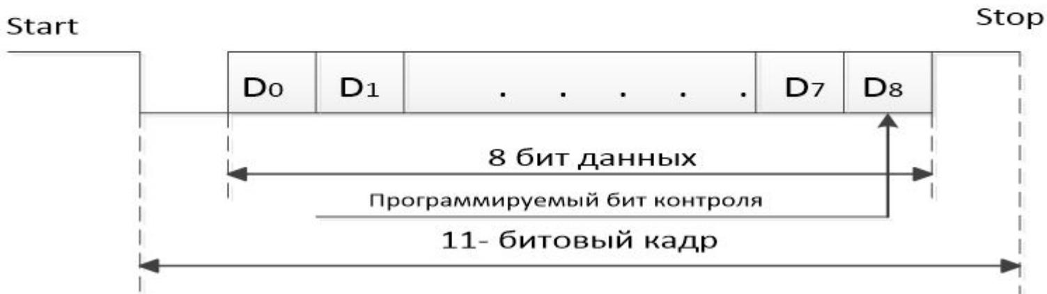
**Два кадра асинхронного обмена модуля UART**
