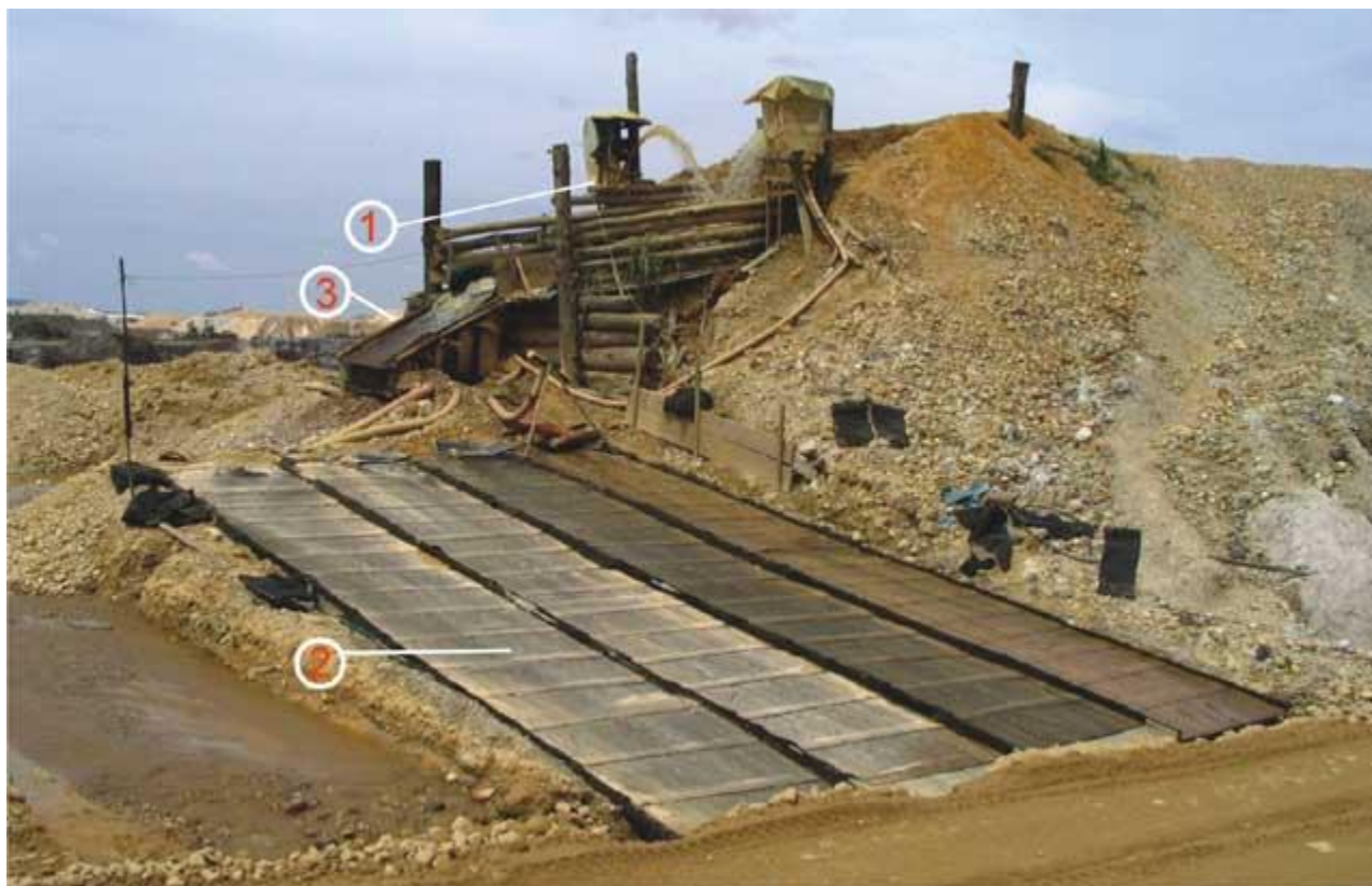
Рис.1 Общий вид промывочного прибора: 1-приемный бункер; 2-шлюзы мелкого наполнения; 3-колосниковый грохот www.zolotodb.ru
