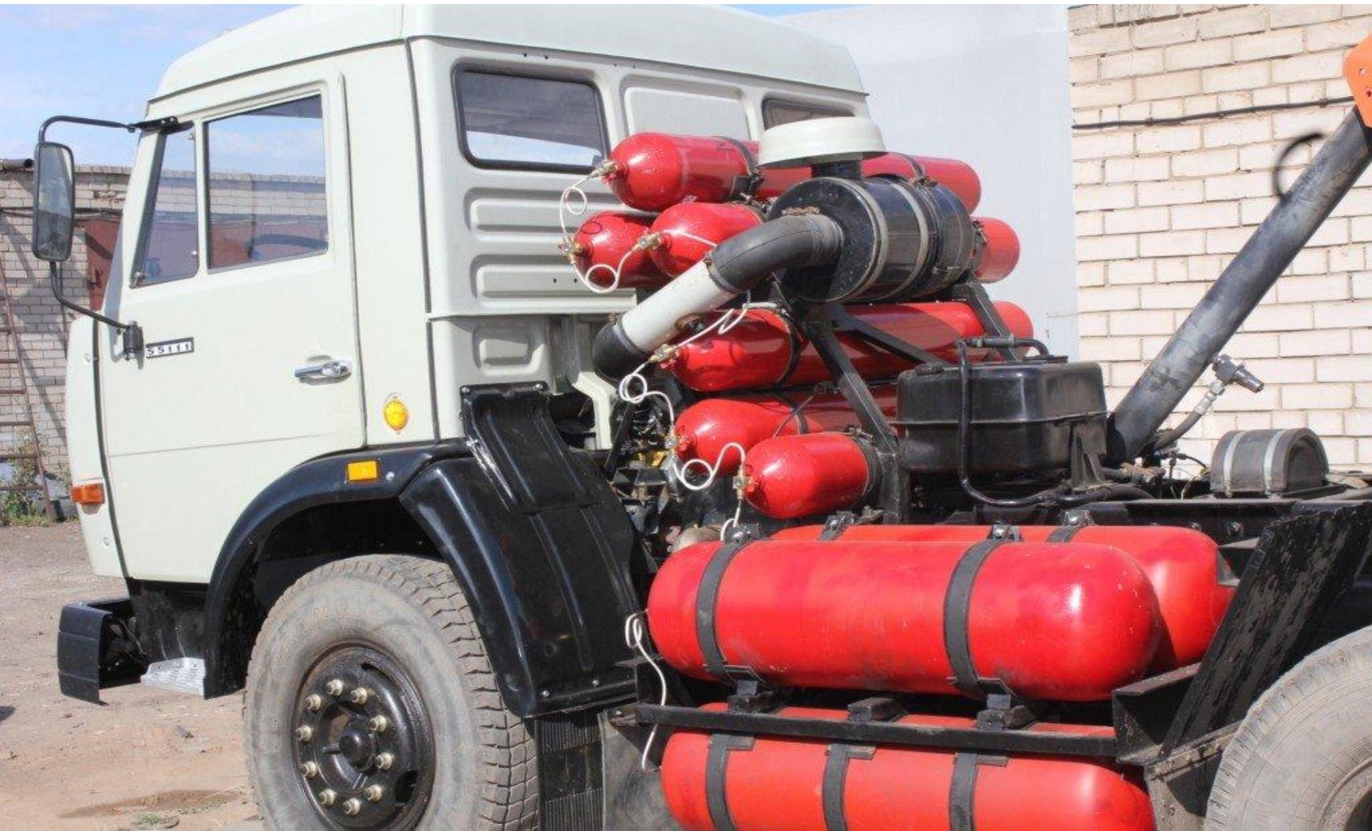
Баллоны для СНГ рассчитаны на избыточное давление 1,6 МПа, а минимальное давление газа в них, при котором сохраняется работоспособность газовой аппаратуры и двигателя, должно составлять 0,06...0,08 МПа.
