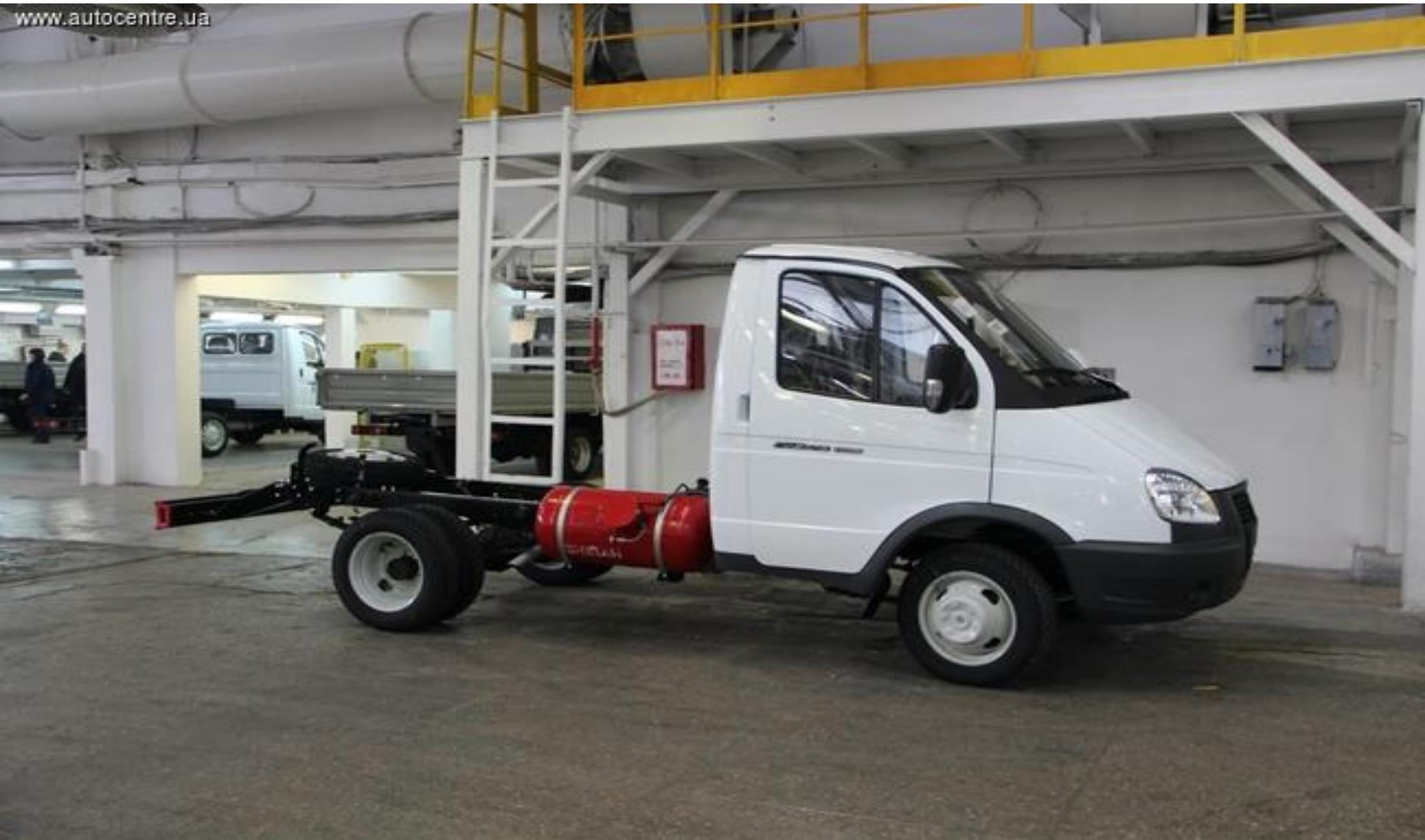
Газобаллонные автомобили, работающие на СПГ, выполнены по универсальной схеме, т.е. эффективно могут работать как на сжатом газе, так и на бензине
