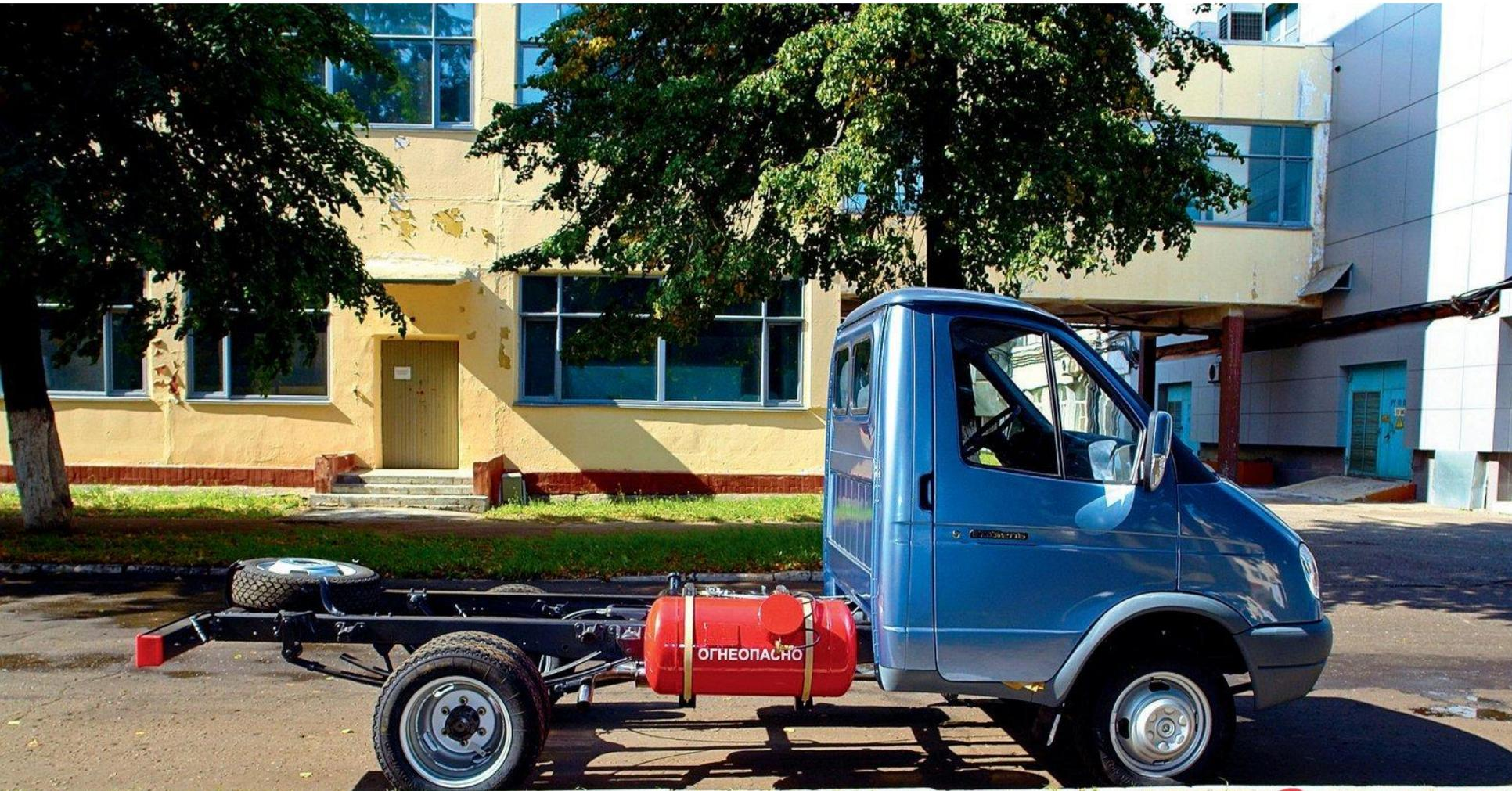
В закрепленных на рамах этих автомобилей баллонах газ находится одновременно в двух агрегатных состояниях: в жидком и газообразном.
