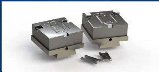
Изготовление ковочных вырубных штампов, закалочных штампов и др. В том числе по специальному заказу(по КД заказчика)
