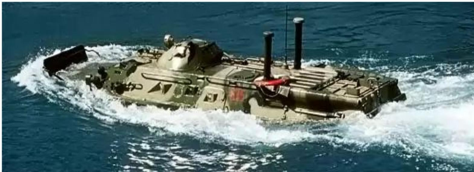
Съемное оборудование для плава служит для предотвращения попадания воды в отделение силовой установки и ФВУ при преодолении водной преграды с высотой волны более 0,5 м. Включает две воздухозаборные трубы.
