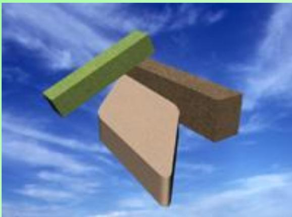
**Бруски** предназначены для шлифовальной обработки различных поверхностей вручную, производятся на керамической или бакелитовой связках из шлифматериалов : электрокорунда нормального и белого, карбида кремния зеленого.
