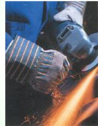
***Абразивный инструмент*** служит для абразивной обработки (шлифования, притирки, полирования и др.); изготавливается из абразивов и связки.
