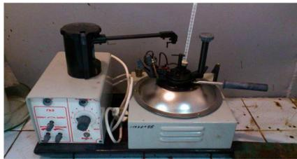
Определение температуры вспышки в закрытом тигле
