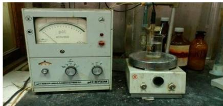
Определение кислотности топлива
