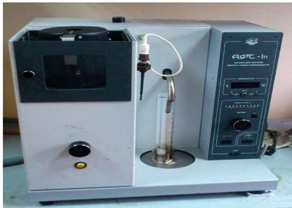
Определение фракционного состава топлива
