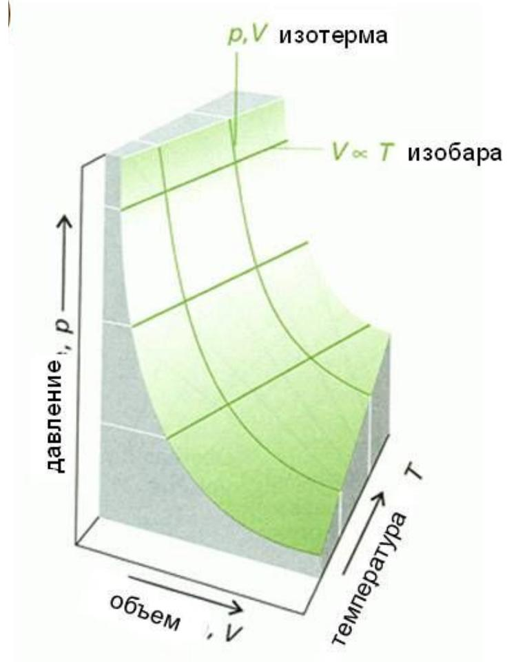
**Давление  $P$**  - сила, действующая на единицу поверхности, называется **удельным давлением**
